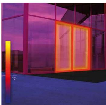
Une façade moderne mais une entrée comportant des profilés conventionnels sans isolation thermique : une perte d'énergie inutile.
