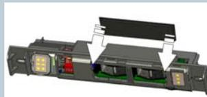
Veillez à insérer les prismes dans les glissières de la base du détecteur (ne pas simplement les placer dans le capot !)
