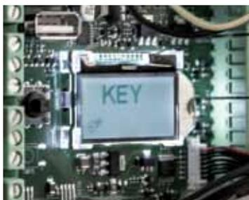
L'affichage LC intégré à l'entraînement guide l'utilisateur pour faciliter la mise en service de l'installation. Aucun appareil externe supplémentaire n'est requis.
